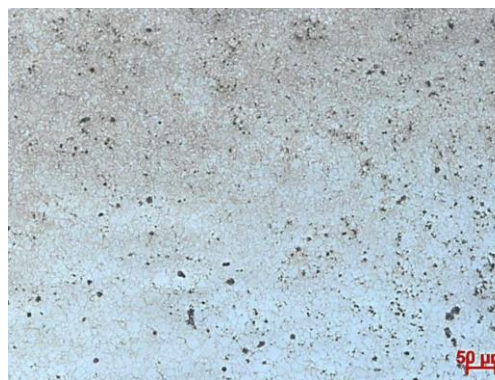
Figura 4: Distribuição do tamanho de grão em matriz austenítica. Os pontos pretos são a carepa formada devido ao processo de aquecimento e resfriamento brusco da amostra. Ampliação: 100x. Fonte: Autora, 2025.
