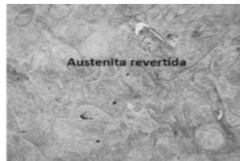
Figura 11: Micrografía longitudinal y transversal del t.t a 490°C/6 hs
