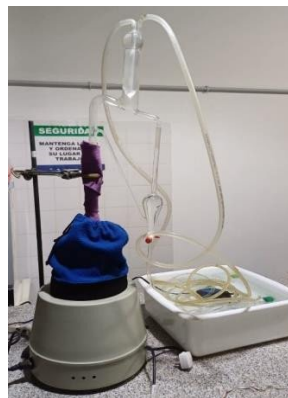
Figura 1. Equipo de destilación utilizado para la obtención del aceite esencial de comino.
