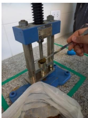
Figura 9. Fabricación de pastillas para colocar en el calorímetro. Fuente: Elaboración propia
