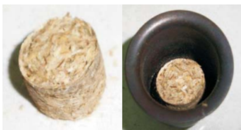
Figura 9. Fabricación de pastillas para colocar en el calorímetro. Fuente: Elaboración propia
