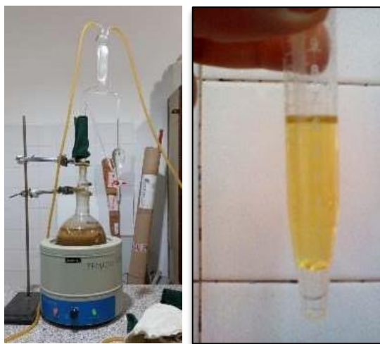
Figura 1. Izq. Montaje del aparato de hidrodestilación para la obtención del aceite esencial de comino. Der. Tubo cónico graduado conteniendo el aceite esencial de comino obtenido.
