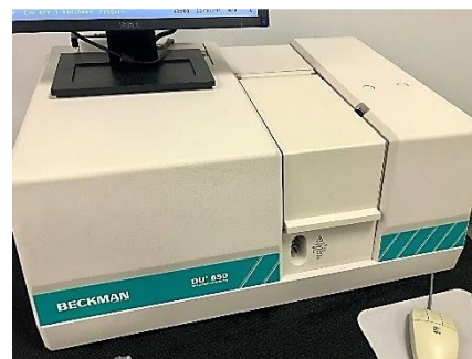
Figura 5. Espectrofotómetro BECKMAN DU® 650 utilizado para la determinación de la densidad óptica (DO) a 620 nm en los cultivos microalgales.
