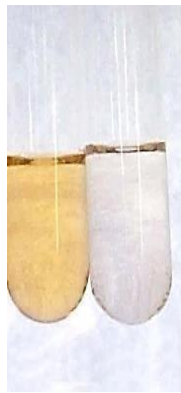
Figura 8. Reacción colorimétrica del método fenol-ácido sulfúrico para la cuantificación de carbohidratos totales. A la izquierda, muestra con carbohidratos que presenta la coloración característica amarillo-anaranjada; a la derecha, blanco de reactivos.
