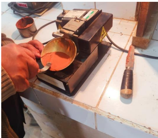
Figura 5. Ensayo de Límites de Consistencia Fuente: Elaboración propia en los Laboratorios IEM - UMSA
