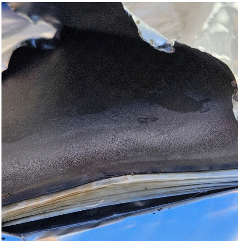
Figura 6: Celda desarmada, se observan las hojas de cátodo y ánodo alternadas.
