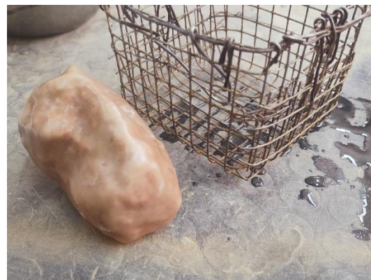
Figura 9. Muestra de Suelo cubierta con Parafina para el ensayo de Trozos Inalterados Fuente: Elaboración Propia Laboratorio de suelos IEM - UMSA
