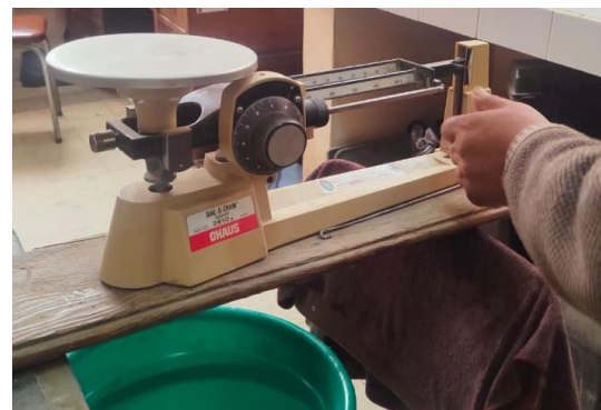
Figura 10. Balanza para medir el Peso de la Muestra cubierta de Parafina Sumergida en agua Fuente: Elaboración Propia Laboratorio de suelos IEM - UMSA
