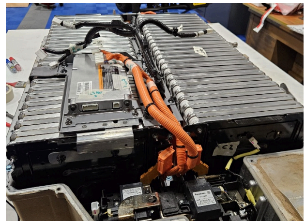
Figura 2: Batería por dentro Renault Kangoo ZE.
