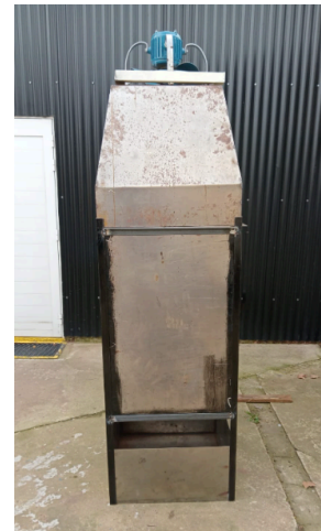
Figura 10: Torre de enfriamiento
