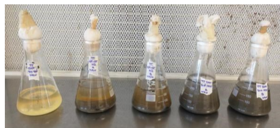
Figura 1. Ensayos de biolixiviación en matraces Erlenmeyer de 250 mL, con sedimentos de Troncos del Talar al 5% y 10% (p/v), controles y cultivos bacterianos Fe-Ox y S-Ox en medio 2K inoculados con azufre pre- colonizado.
