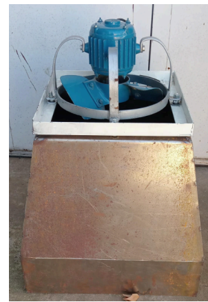
Figura 9: Sistema de extracción.
