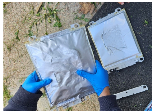
Figura 5: Celdas separadas Renault Kangoo ZE.
