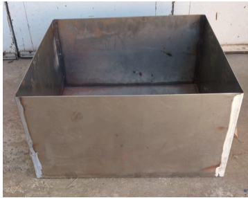
Figura 5: Bacha de la torre
