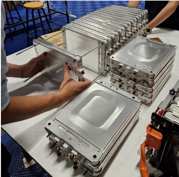
Figura 3: Extracción de módulos
