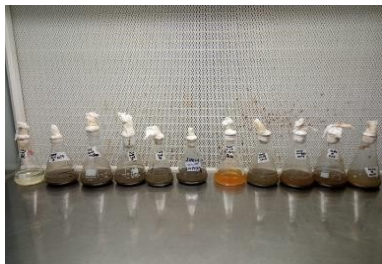
Figura 1. Ensayos de biolixiviación a escala de laboratorio en matraces Erlenmeyer de 250 mL (frascos agitados).
