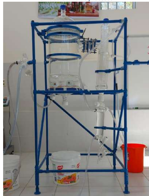
Gráfico 7 – Equipo de extracción de aceites esenciales en el Laboratorio de procesos
