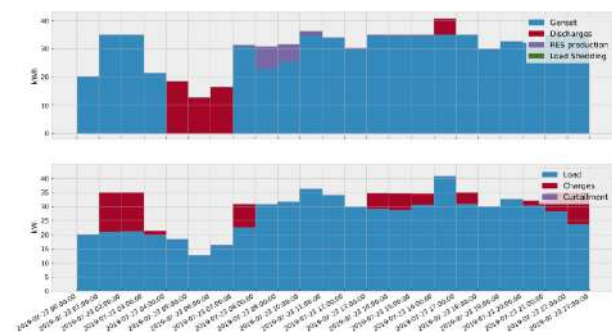
Figura 10. Potencia generada del caso PSDS utilizando un algoritmo MPC (controlador de optimización) el 23 de julio en Pojo Pata.
