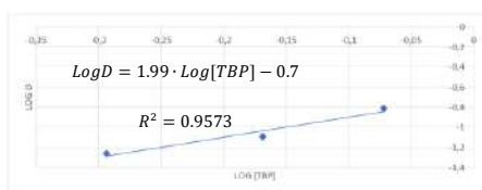
Figura 4. Estequiometría TBP en la SX de Co - Cyanex 272 / [P 66614 ][Tf 2 N].
