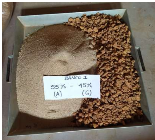
Figura 8. Material usado para la ejecución de combinación 45%grava-55%arena – Banco 1
