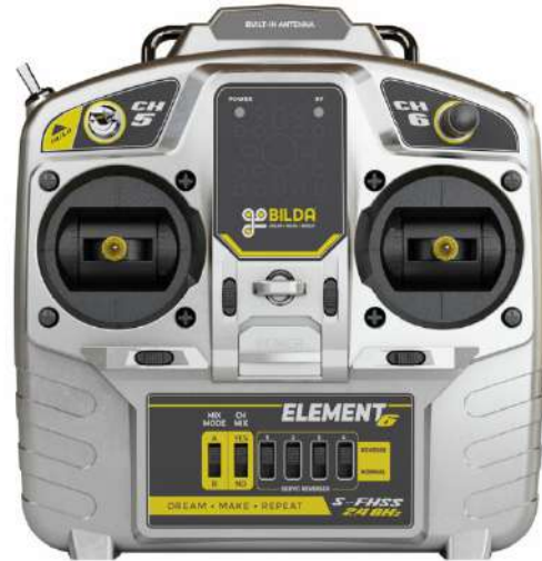
Figura 16 . Radio control para desplazar a RISSA (modelo Element 6 de GOBILDA)
