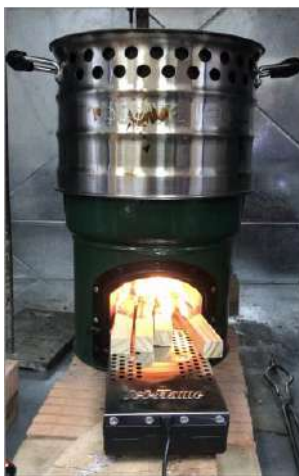
Figura 7. Sistema de combustión a biomasa
