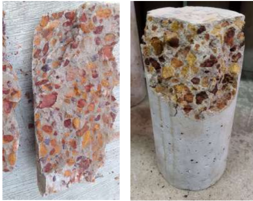
Figura 13. Composición interna de agregados en los cilindros ensayados
