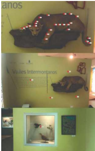
Figura 8. Puntos seleccionados para la toma de niveles de iluminación en una de las salas de exposiciones/exhibiciones permanentes (puntos sobre ejemplar - análogos a los del ejemplar almacenado-, pared posterior y vidrio transparente de la vitrina más próxima).
