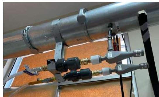
Figura 5. Ciclones para gravimetría de material particulado PM 2.5
