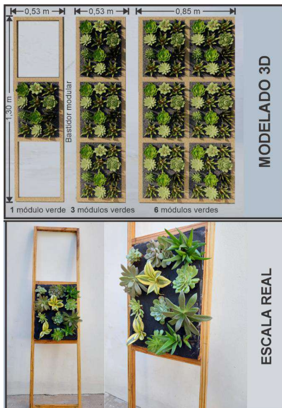
Figura 1: Sistema plantAR. Ariba el modelado 3d y abajo el prototipo en escala real. Fuente: Elaboración propia (2022).
