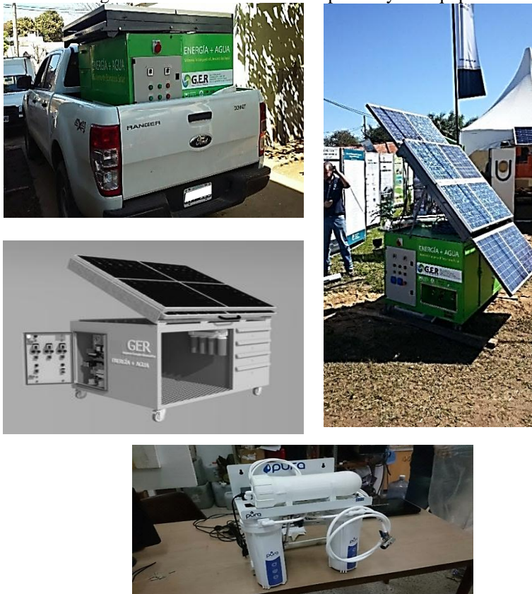
Figura n.º 14. Fotografías del sistema de bombeo portátil y del equipo de filtrado incorporado
