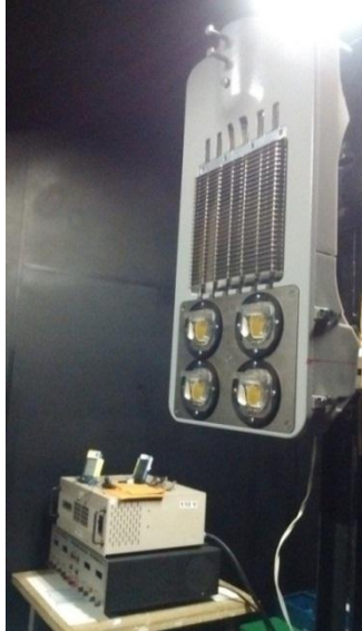
Figura n.º 10. Luminária WLEDi montada no GAC, posição inicial (plano C = 0^\circ - 180^\circ ) vertical de simetria, data da realização: 22/Ago./2016 [11]
