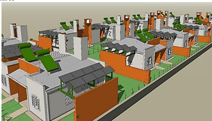
Figura 15: Diseño conceptual para la integración de sistemas FV conectados a red y de calefones solares
