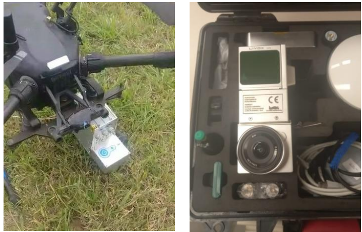
Figura 7. Disposición del sensor integrado LiAir V70 en la parte ventral del UAV DJI Matrice 210 (izq.). Detalle de la cámara Sony 5100 integrada en la carcasa del sensor (der.). Fuente: los autores.
