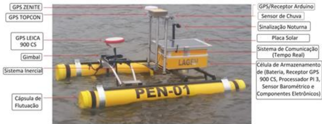
Figura 2. Estrutura da PEN-01 em levantamento de campo. Fonte: VISKI, 2017.
