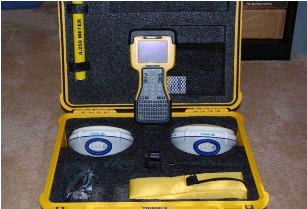
Figura 2: Receptor GNSS R6 e coletor de dados TSC3 (Trimble, EUA). Fonte: https://geostar.lv/en
