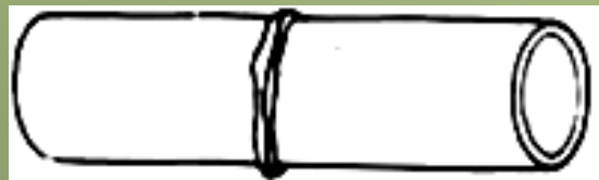
Deficiencia del cordón exterior por presión excesiva durante el ciclo de calentamiento
